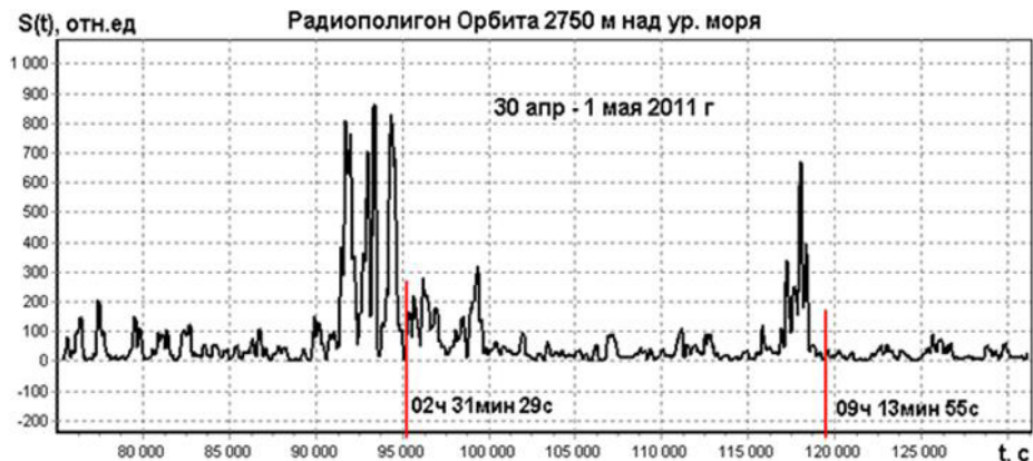
Рисунок 5 - Динамический спектр мощности вариаций атмосферного электричества во время Капчагайского землетрясения и его афтершока, произошедших 1 мая 2011г. в 02ч 31мин 29с и в 09ч 13мин 55с.
