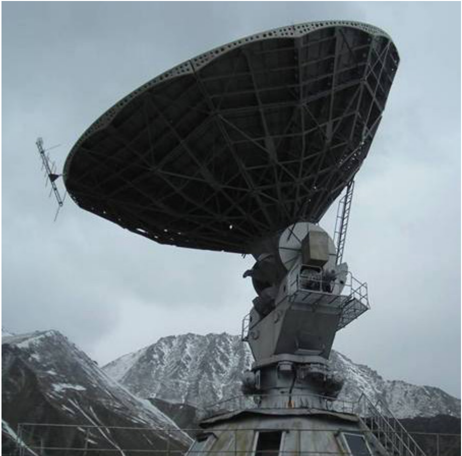
Рисунок 1 – Общий вид ТНА 57М с логопериодической антенной радиоспектрографа на нижнем срезе зеркала
