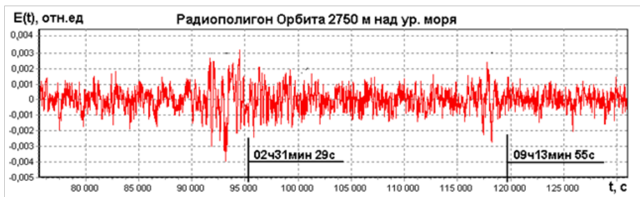
Рисунок 4 – Вариации атмосферного электричества на радиополигоне «Орбита» во время Капчагайского землетрясения и его афтершока, произошедших 1 мая 2011 г. в 02ч 31мин 29с и в 09ч 13 мин 55с. Вертикальными линиями на графике обозначено время землетрясений. По оси X - время от начала суток 30.04.2011 г по времени GMT в секундах. Для удобства просмотра графики смещены по оси Y.
