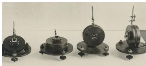
Кварцевые вариометры системы Боброва В.Н. (Т-, Z-, H- и D- компонент)
