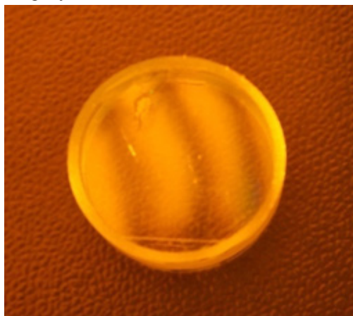
Рисунок 9 – Результаты контроля линз методом интерференции с помощью пробных стекол
