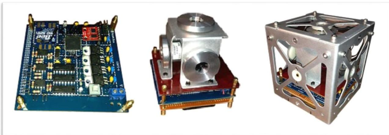
Система управления движением и навигации спутника научного назначения
