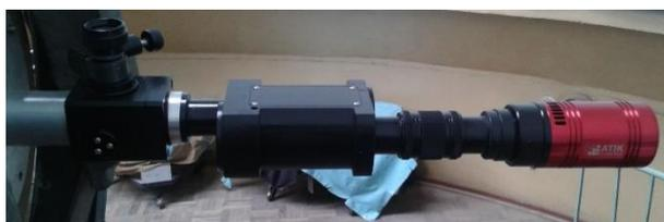
ПЗС-спектрограф, установленный на 70-см телескопе АЗТ-8
